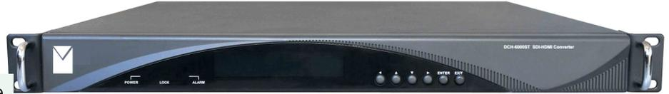
Le DCH-6000ST est un convertisseur de signal vidéo numérique professionnel 4K, il dispose de 2 paires 4 \* 3G SDI et 2 ports HDMI dans un châssis 1U, et prend en charge le signal 4K HDMI converti en signal 4K SDI via un port SDI 1 \* 12G ou une sortie SDI 4 \* 3G ; non seulement cela, le DCH-6000ST prend également en charge le signal 4K SDI via le port SDI 1 \* 12G ou l'entrée 4 \* 3G SDI dissimulée en signal HDMI 4K. Il peut également être contrôlé et supervisé par SNMP et HTTP Web.
