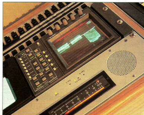
Poste de contrôle des signaux en composantes et de l'audio.
